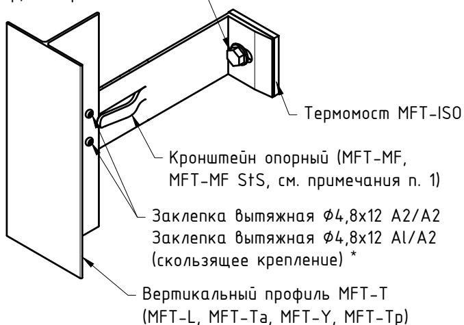
Узел №3 (увеличено, вариант с кронштейном MFT-MF H)
